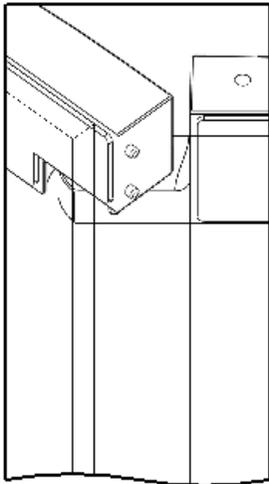
● Avant de coller le joint (N), la surface doit être nettoyée, dégraissée et sans poussière, avec un nettoyeur à base d'alcool.
