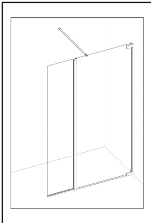
➊ Vous avez la possibilité de réaliser un montage à droite ou un montage à gauche. Notre notice d'installation décrit un montage à gauche. Si vous voulez réaliser un montage à droite, il vous suffit d'inverser le montage.
