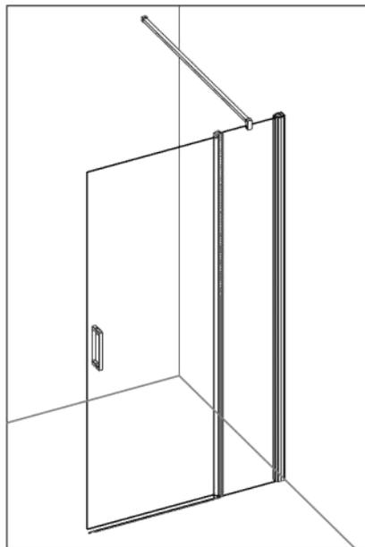
**F** Vous avez la possibilité de réaliser un montage à droite ou un montage à gauche. Notre notice d'installation décrit un montage à gauche. Si vous voulez réaliser un montage à droite, il vous suffit d'inverser le montage.
