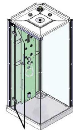
Vous avez la possibilité de réaliser un montage à droite ou un montage à gauche. Notre notice d'installation décrit un montage à droite. si vous voulez réaliser un montage à gauche, il vous suffit d'inverser le montage.
