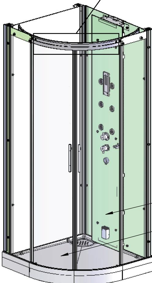
Placer les roulettes dans les rails puis fixer les portes dans les roulettes.
