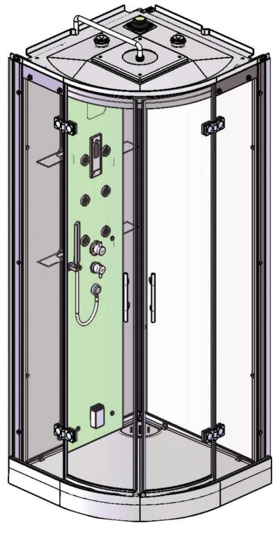
Vous avez la possibilité de réaliser un montage à droite ou un montage à gauche. Notre notice d'installation décrit un montage à droite. si vous voulez réaliser un montage à gauche, il vous suffit d'inverser le montage.
